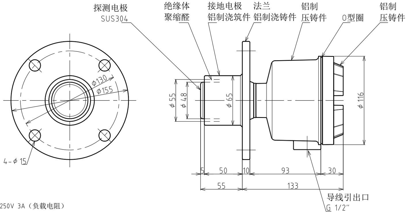
接点输出:AC250V 3A (负载电阻)
