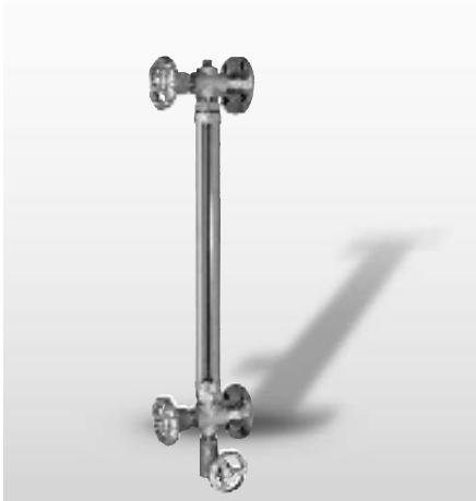
TUP N-10 (汎用型フランジタイプ) 接続：フランジ パイプ種類：φ19赤線入硝子管・各種樹脂管 材質：炭素鋼・ステンレス鋼 使用圧力：-0.1~0.7MPa
