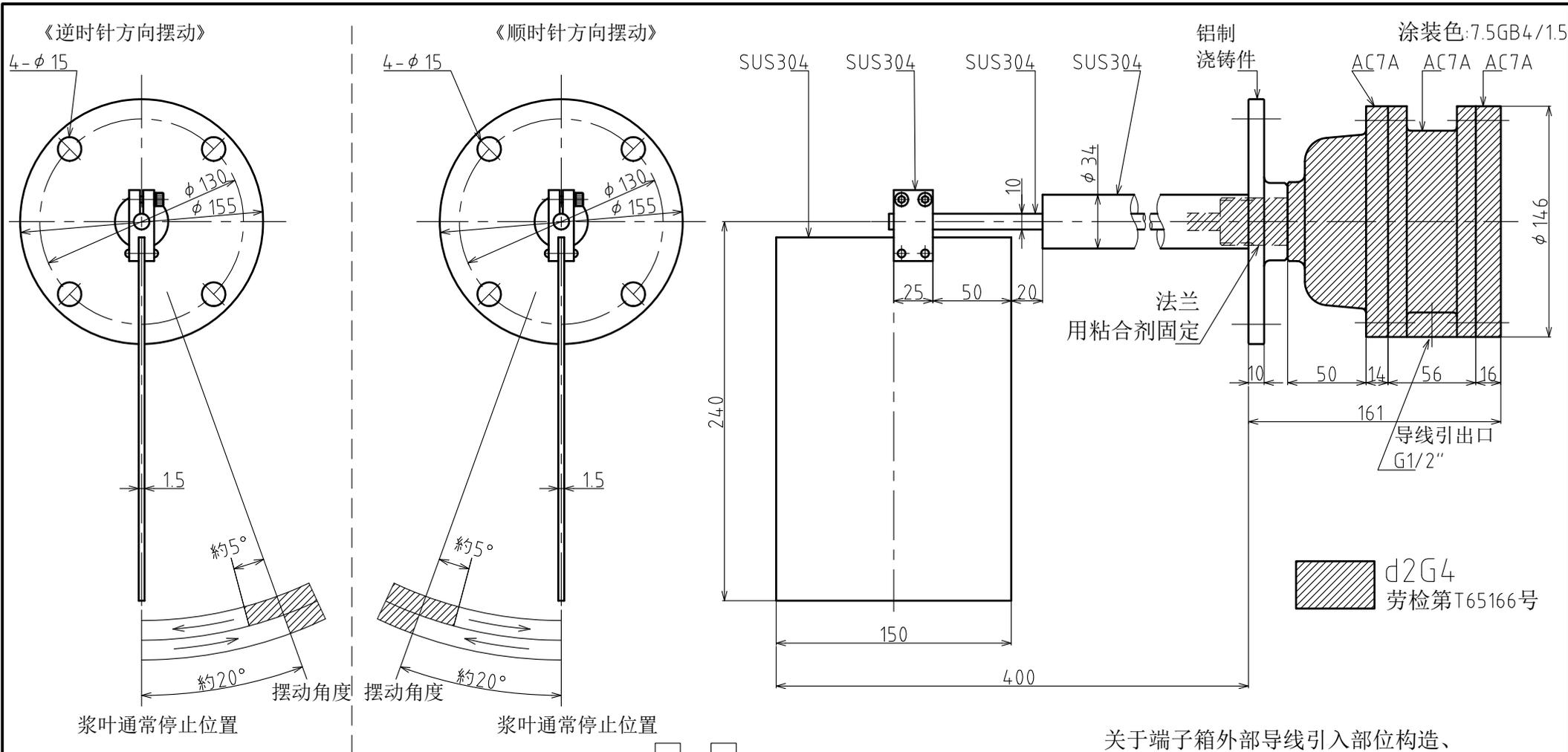
※通过报警器有「顺时针方向摆动型」和「逆时针方向摆动型」，请确认贵司应该使用哪一种规格或型式的产品。
